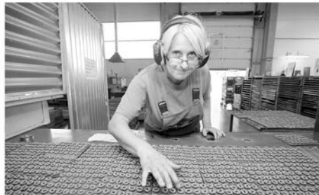
Samotná výroba je do veľkej miery automatizovaná a je približne sedemkrát rýchlejšia ako výroba klasickou technológiou. Vo forme sa zlisuje zmes kovov v prášku a ten smeruje do pece. Vznikajú tak napríklad súčiastky do brzd na autách. (JKU)
