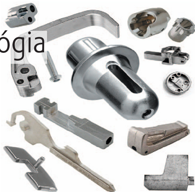
Príklady súčiastok vyrobených MIM technológiou.
