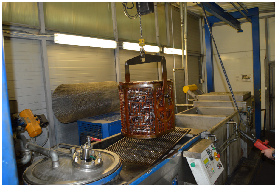
Výrobná linka na impregnáciu pórovitých materiálov špeciálnou živicom
