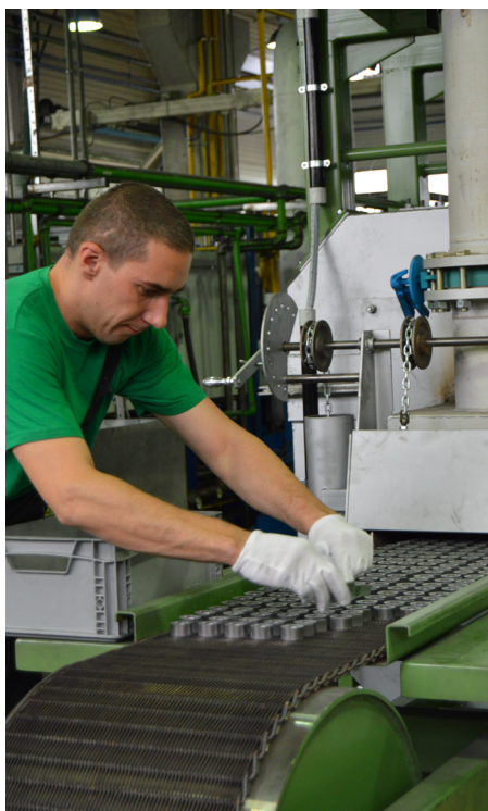
Veľkokapacitná linka na oxidačné černenie kovových výrobkov
